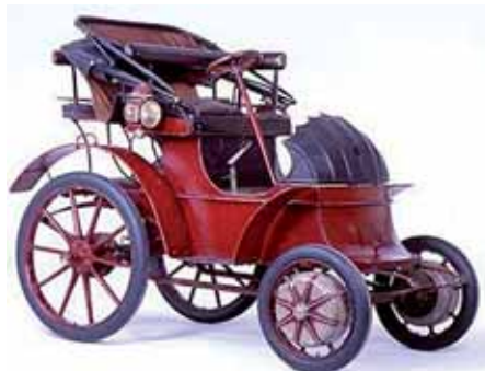
Visionário – Porsche de 1900 – Veículo Eléctrico que integrava já os motores nos cubos das rodas anteriores.
